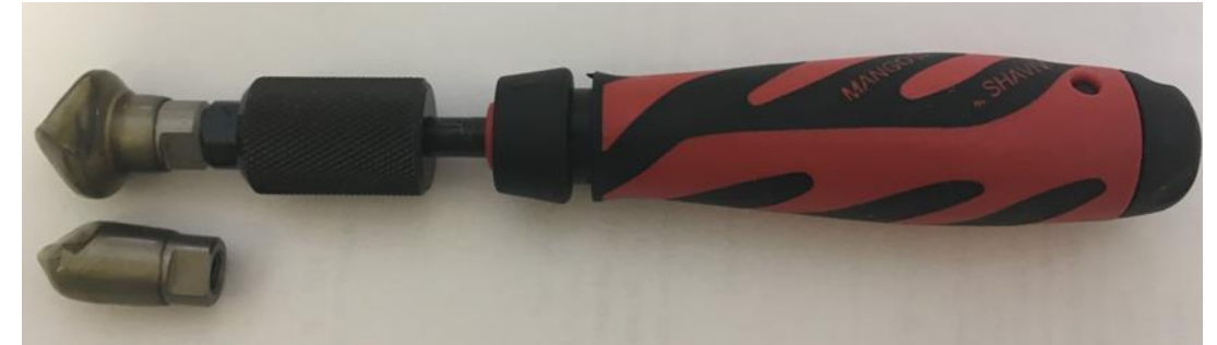
Фаскосниматель состоит из корпуса и сменного зенкера
